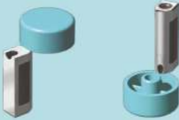
Düz yüzeyde destek takesiyle yolluk verme
