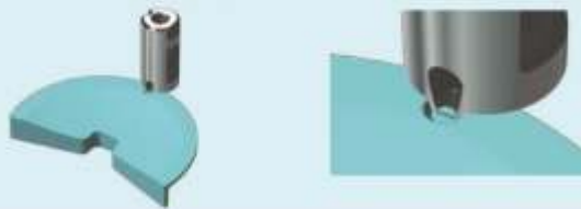
Düz yüzeyde destek takesiyle yolluk verme
